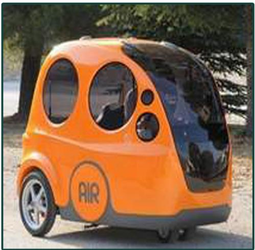
قال مهندس السيارات الفرنسي "غاي نoyer" أنه طور سيارة تعمل بالهواء المضغوط: تنتج احتكاكاً من غازات الكربون لمحرك قياسي وتصل سرعتها إلى أكثر من 45 كم في الساعة وتستطيع السفر لمسافة نحو 105 كم بإعادة شحنها لمدة دقيقة واحدة. والأفضل من ذلك، أن كلفتها نحو 4500 دولار فقط.
